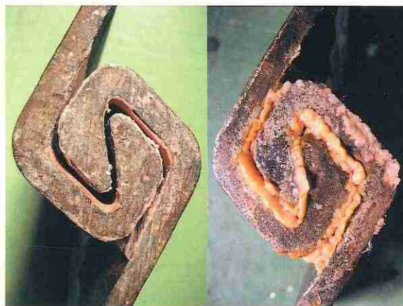
浸漬前 浸漬後 写真-1 パイルロックの膨潤状態
