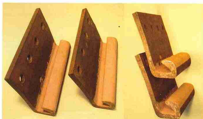
写真―11 パイルロックを塗布した継手
