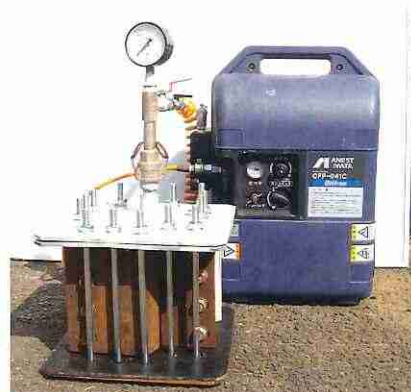
写真―12 止水圧試験システム
