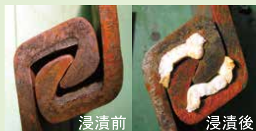
写真-1 パイルロックNS-vの膨潤状態
